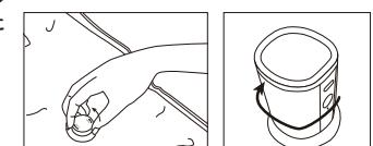
②圧縮袋のバルブのふたを外し、本品の吸引口をバルブに合わせて時計回りに回して取り付けてください。
