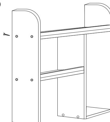
取り付けた棚板②と③の逆側に、左側板⑥の側面穴位置を合わせて、ネジを外側から差し込み取り付けてください。
