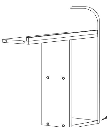
右側板①の上段の外側ネジ穴に、上棚板②の側面穴位置を合わせて、ネジを外側から差し込み、付属のドライバーで取り付けてください。棚板はストッパーの付いている方を上向きにしてください。
