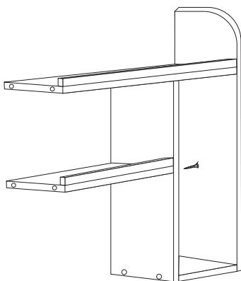
側板④の中央の穴に、棚板③の側面穴位置を合わせて、ネジを外側から差し込み取り付けてください。
